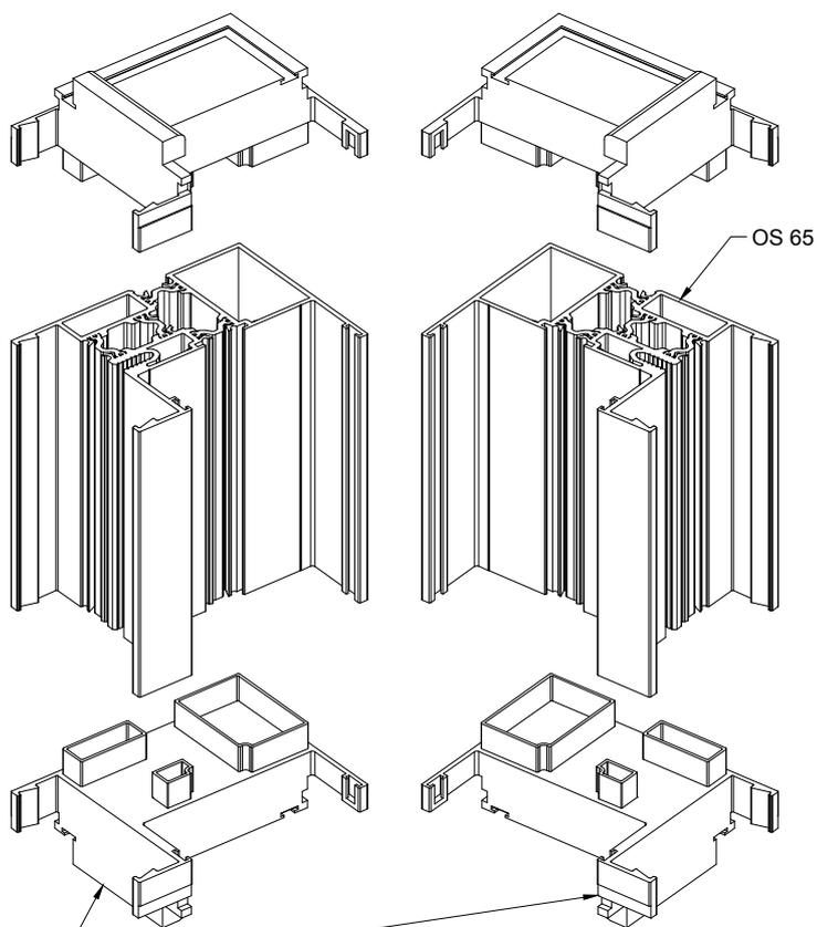
Com a rotação das peças no plano XY, obtêm-se as peças esquerdas ou direitas.
