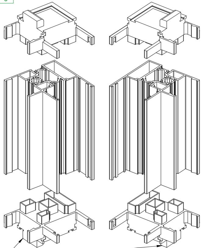
Com a rotação das peças no plano XY, obtêm-se as peças esquerdas ou direitas.
